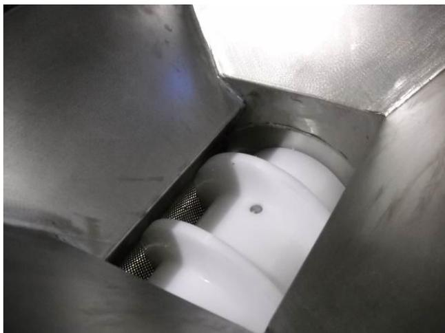
Une conformation spéciale de la trémie permet à l'opercule d'être mieux introduits dans la vis sans fin, empêchant l'accumulation à l'extérieur.
