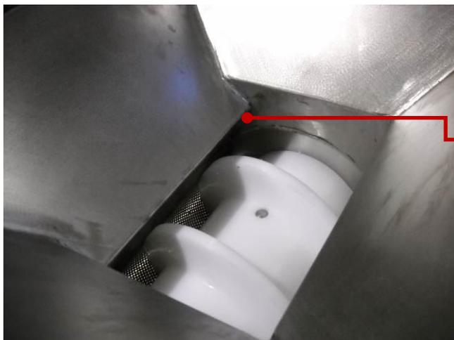
Una conformazione speciale della tramoggia, con un leggero sottosquadro, permette all'opercolo di inserirsi in maniera migliore all'interno della coclea, impedendo l'accumulo all'esterno.
