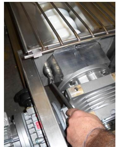
Schrauben Sie die 4 Sechskantschrauben wie in der zweiten Abbildung dargestellt, mit einem 17er-Gabelschlüssel aus.
