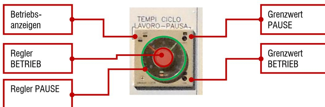
Abgesehen von der Möglichkeit, wie oben beschrieben, die Rotationsgeschwindigkeit der Schnecke zu verändern, können auch Pausen- und Betriebszeiten der Rotation der Schnecke gesteuert werden.
