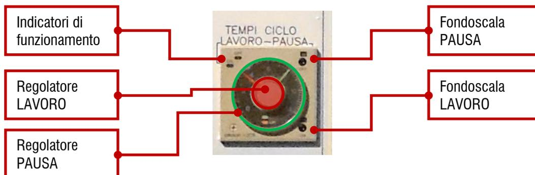
Oltre a poter variare la velocità di rotazione della coclea, come abbiamo visto, è possibile facilmente gestire anche periodi di pausa e lavoro nella rotazione della coclea stessa.
