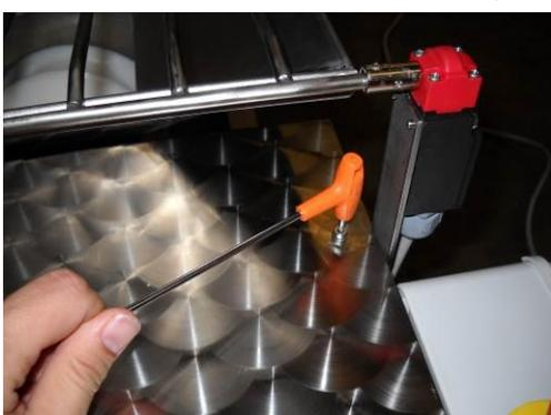
Pour une maintenance extraordinaire, vivement conseillée en fin de saison, le cylindre grillagé peut être démonté comme suit. Démontez le carter de protection du moteur à l'aide des vis comme le montre la photo à l'aide de la clé Allen de 4.
