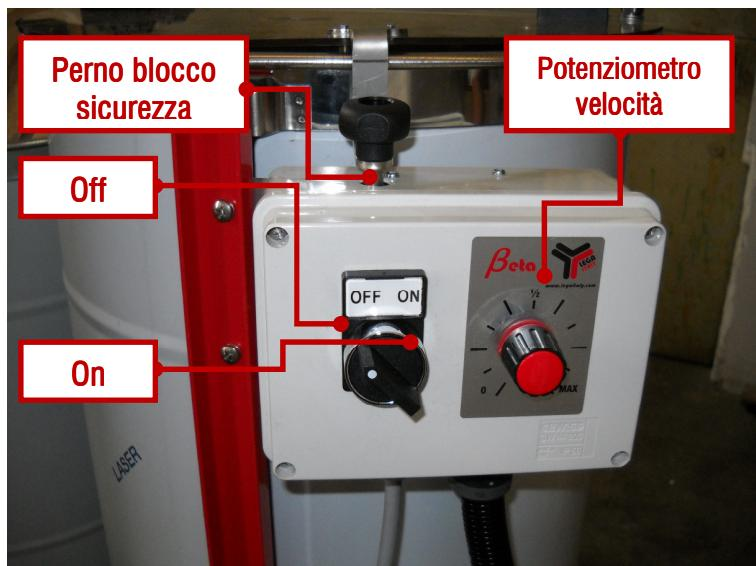
Disporre i favi in modo che siano bilanciati all'interno della gabbia; chiudere il semi coperchio facendo attenzione che il perno del blocco di sicurezza entri perfettamente nel foro del quadro elettrico.
