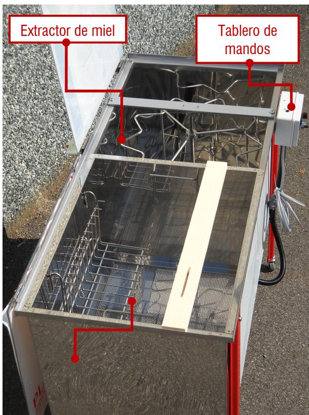
Coloque el extractor de miel TWIN en posición segura y cómoda. Conecte el enchufe a una toma eléctrica que cumpla los requisitos de seguridad previstos por las normas vigentes.
