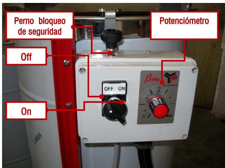
Coloque los cuadros de tal forma que queden equilibrados dentro de la jaula; cierre la semitapa verificando que el perno del bloqueo de seguridad entre perfectamente en el orificio del tablero eléctrico.
