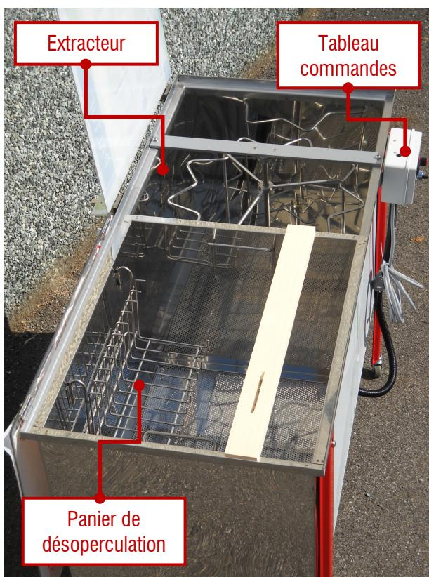
Installer l'extracteur TWIN dans une position sûre et pratique. Brancher la fiche dans une prise électrique conforme aux exigences de sécurité des normes en vigueur.
