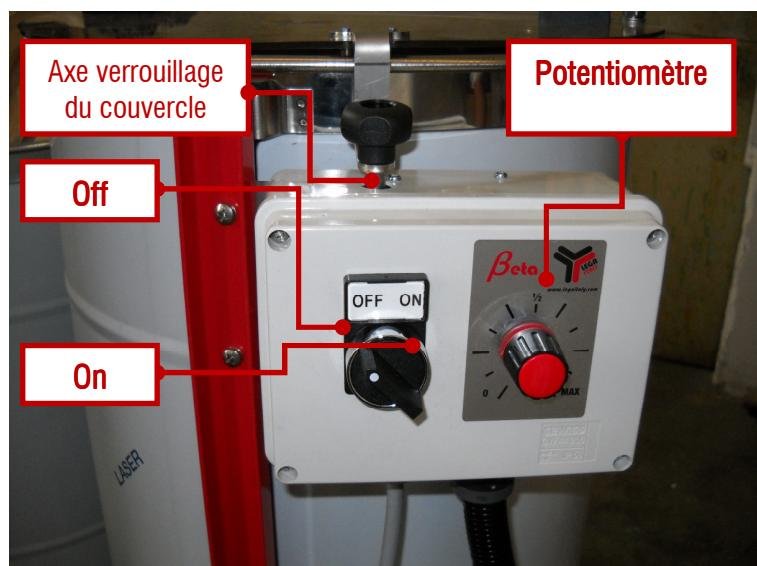
Disposer les cadres de manière à ce qu'ils soient équilibrés à l'intérieur de la cage ; fermer le demi-couvercle et tourner le sélecteur sur ON.
