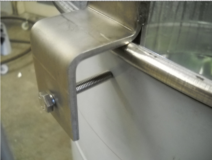
Die Halterung des Schwimmers wird, wie auf Abbildung 2 zu sehen, am Rand des Reifebehälters oder des Absetzbehälters befestigt.
